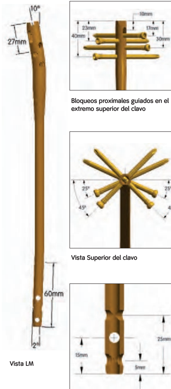
Los bloqueos distales del clavo no son guiados (vista AP)
