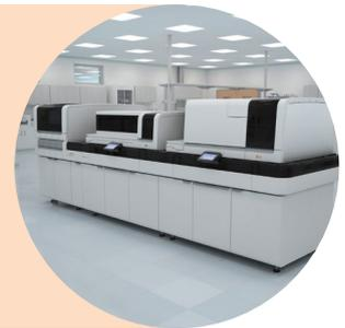
**Atellica™ Sample Handler** es el componente de procesamiento de muestras de Atellica Solution y sirve como la interfaz de entrada/salida, independiente de la cantidad de analizadores conectados. El transporte patentado de Atellica Magline™ conecta todos los componentes en un flujo de trabajo integrado. El sistema de visión multicámara, con vista en 360°, está diseñado para reducir los errores de lectura de los códigos de barra, el manejo de excepciones y la intervención del operador
