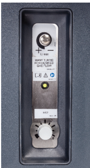
El mezclador electrónico de gases integrado puede ser controlado a través del Monitor de Control Central o localmente.
